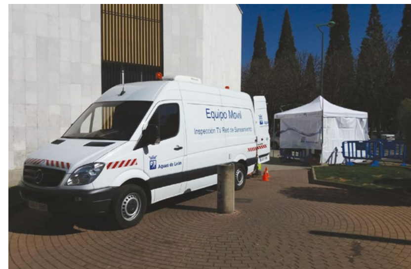
Equipo de inspección con cámara de TV de la red de saneamiento.
